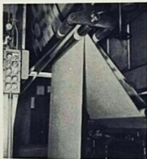
Fig. 179. Entrada de la cinta de papel en el elemento de impresión.
