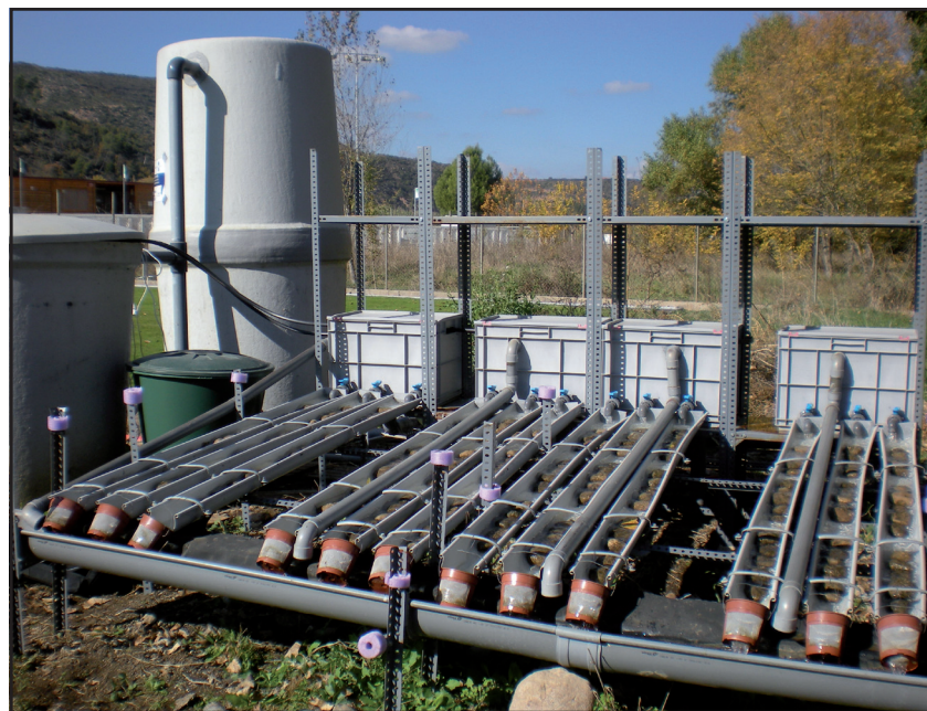
Figura 1. Fotografía del mesocosmos Sostaqua. A la izquierda pueden verse los dos depósitos reguladores (grande = 4000 l de capacidad y pequeño = 2000 l de capacidad). El agua de los depósitos alimenta cuatro depósitos en cabecera que suministran agua a los canales experimentales.
