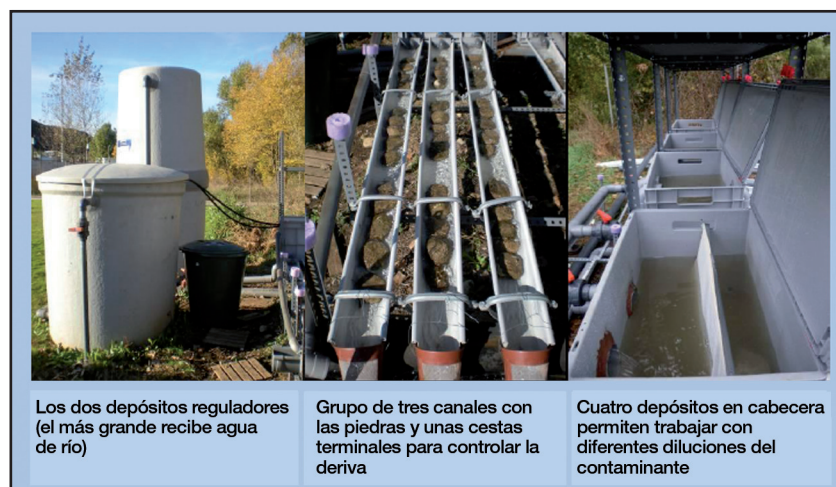
Figura 2. Componentes principales del mesocosmos Sostaqua. A la izquierda, los depósitos reguladores; a la derecha, los depósitos de cabecera; y en el centro, los canales experimentales con las piedras y las cestas de deriva.
