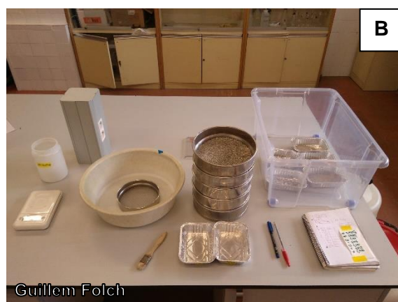
Figura 4. Diferentes instrumentos utilizados en el análisis granulométrico para la limpieza de las partículas más finas (A) y el fraccionamiento en función del tamaño de grano (B).
