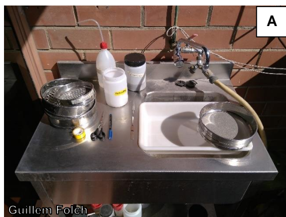
Figura 4. Diferentes instrumentos utilizados en el análisis granulométrico para la limpieza de las partículas más finas (A) y el fraccionamiento en función del tamaño de grano (B).
