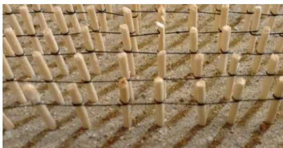
Figura 5. Detall del fil de cosir que uneix lateralment els escuradents. La rugositat dels escuradents juntament amb la tensió del fil impedeix que aquest es desplaci amunt o avall, de manera que queda fixat.
