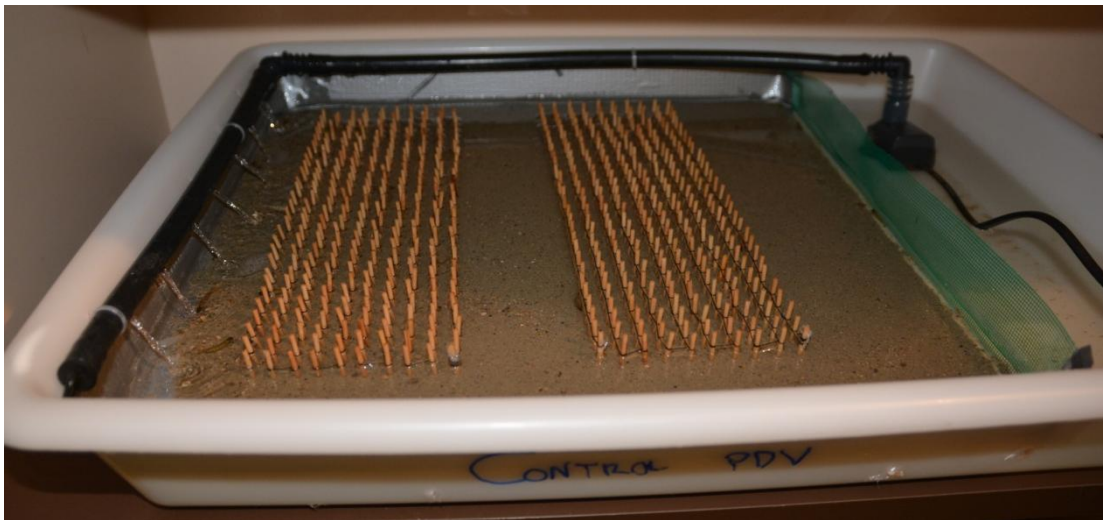
Figura 6. Muntatge acabat i en funcionament del microcosmos definitiu per a Hydropsyche exocellata .
