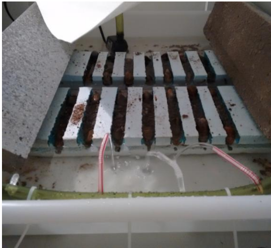
Figura annex 4. Muntatge final en una de les safates. Les planxes de poliestirè es mantenen enfonsades gràcies a les llambordes. Les canyes permeten dirigir el flux d'aigua perquè no impacti directe sobre els canals.
