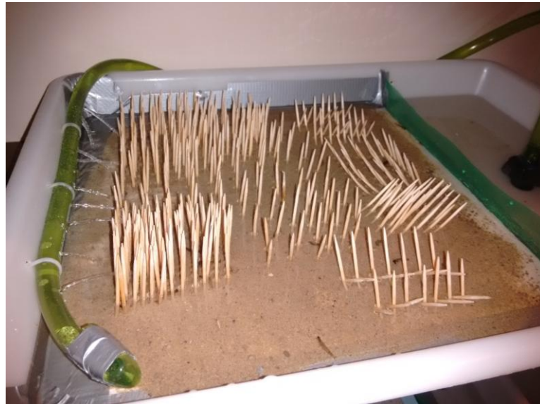
Figura Annex 10. Muntatge complet del disseny amb superfície llisa cara amunt i escuradents com a punts de suport. Es van provar diferents disposicions per veure quina oferia millors resultats. En la fotografia es pot observar el sistema en funcionament amb els H. exocellata .
