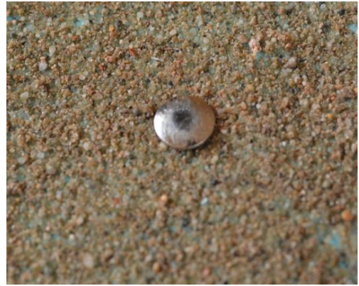
Figura Annex 9. Les xinxetes clàssiques (o de cap rodó) permeten mantenir un petit espai de pocs mil·límetres entre la planxa de poliestirè i la base de la safata. Se'n van utilitzar un total de cinc.
