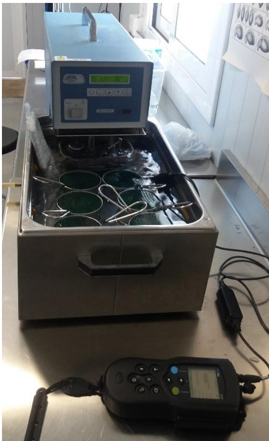
Figura 1. Diseño experimental utilizado para medir la Temperatura crítica máxima y la tolerancia al frío de Calotriton arnoldi .
