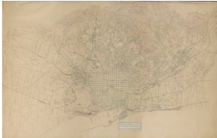
Figuras 6 y 7. Arriba. Red de canalizaciones eléctricas para alumbrado establecidas por la Compañía Barcelonesa de Electricidad. [1929]. La leyenda señala en un tono más suave el alumbrado provisional, en rojo intenso el alumbrado definitivo y en líneas discontinuas el alumbrado en proyecto.
