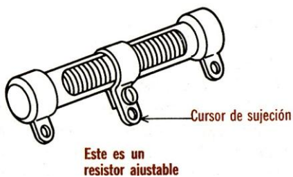
Figura 4. Representación simple de resistor ajustable. Fuente: Mileaf 1984.
