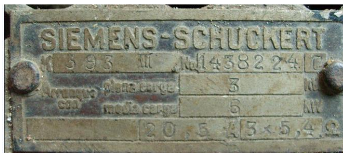
Figura 3. Placa de características. Reóstato Siemens – Schuckert
