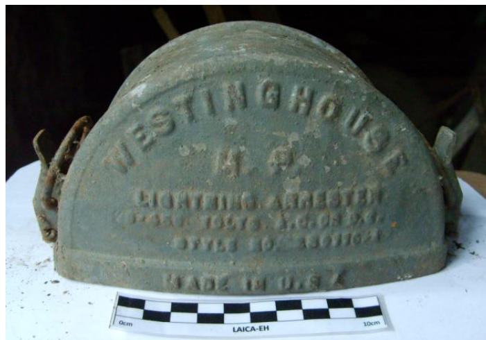
Figura 12. Tapadera de pararrayos localizada junto con las demás máquinas eléctricas ya descritas.
