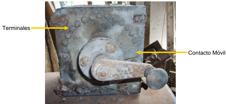
Fotografía 6. Vista frontal de Reóstato.
