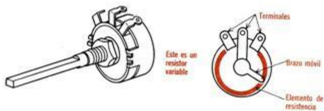
Figura 5. Representación simple de resistor variable. Fuente: Mileaf 1984.
