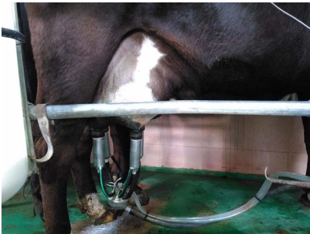
Ilustración 9. Esta foto muestra el funcionamiento y colocación de las pezoneras durante el ordeño.
