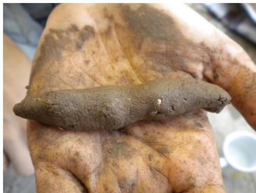
Prueba para la determinación de arcilla: chorizo (10% arcilla)
