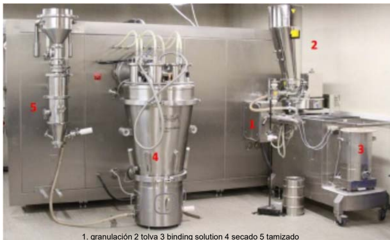
1. granulación 2 tolva 3 binding solution 4 secado 5 tamizado
