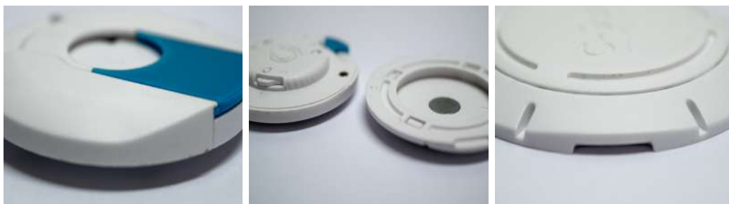
Fig 10. Policarbonato utilizado en las piezas del mecanismo. Elaboración propia.
