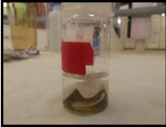
Figura 14: Mostra de fitobentos filtrat dissolta en acetona
