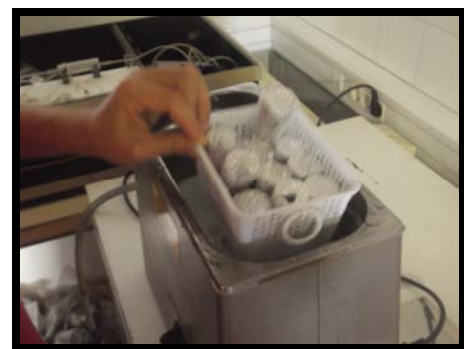
Figura 16: Sonicador amb les mostres d'algues i acetona dins els vials
