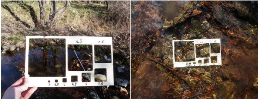
Figura 3: Granulòmetre emprat per quantificar la granulometria dels 16 transsectes i els 9 punts de mostreig. Les mesures exactes dels diferents orificis s'exposen a la Taula 2B de l'Annex.
