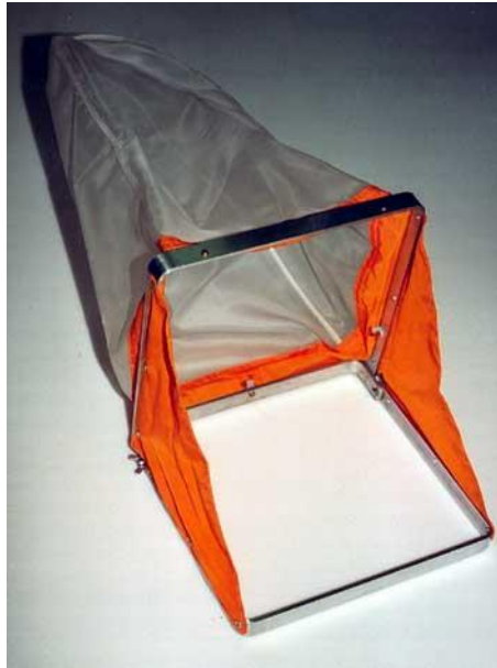
Figura 5: Xarxa Surber emprada pel mostreig de macroinvertebrats (superfície de 0.1 \text{ m}^2 ).
