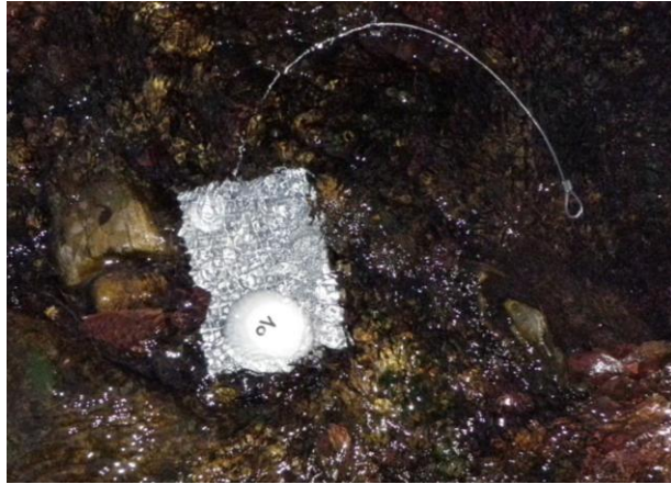
Figura 4: Placa de plexiglàs i hemisferi Fließwasserstammtisch o FST (nº10 de les 24 existents) realitzant proves en la Riera de Santa Fe.
