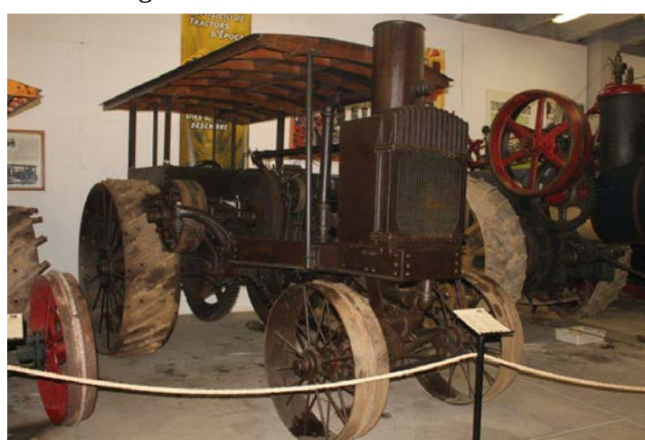
Un formidable tractor de motor de explosió amb benzina, de 1916, model "20-40 HP", bicilíndric en boxer de 14.730 cm 3 , que esta en funcionament.
