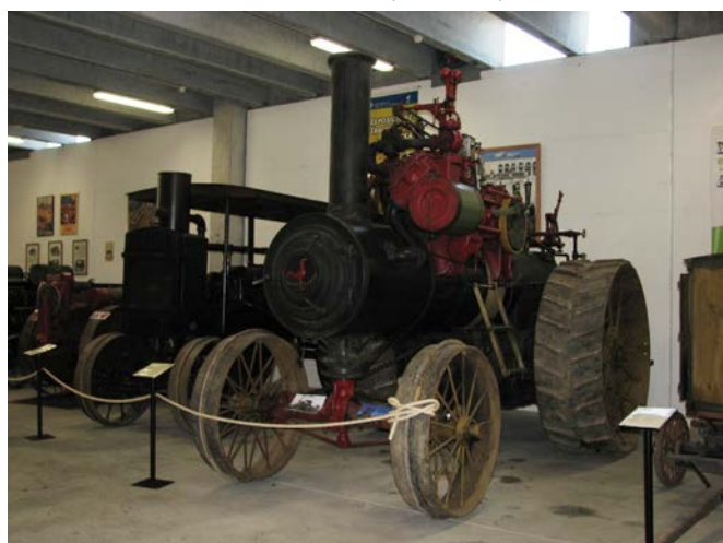
Un formidable tractor de motor de explosió amb benzina, de 1916, model "20-40 HP", bicilíndric en boxer de 14.730 cm 3 , que esta en funcionament.
