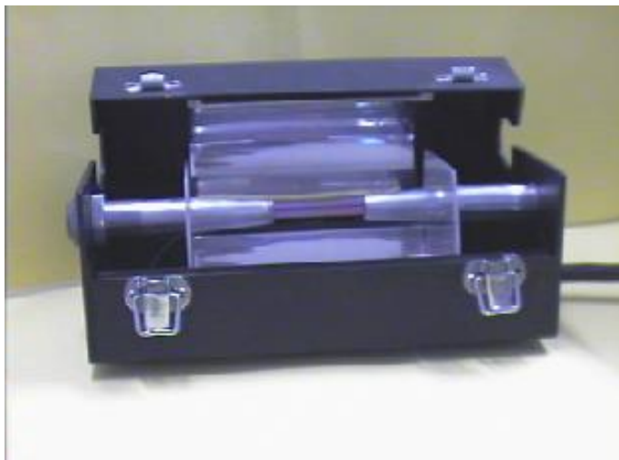
Fig. 3. La emisión inducida, introducida por Einstein en 1917, sería el fundamento del láser. Aquí se muestra uno de rubí, adquirido en 1962 por la Universidad de Barcelona, muy parecido al primer láser de rubí, construido por T. H. Maiman en 1960. (Fotografía de S. Vallmitjana).
