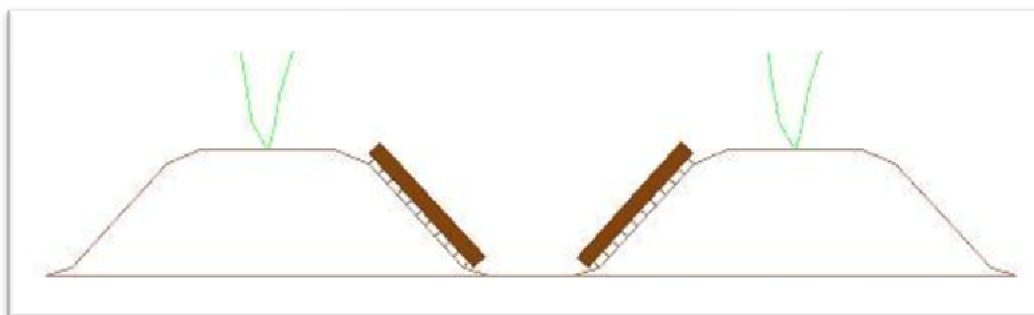
Figura 26. Esquema representatiu de la posició de l'entauladora treballant entre dos cavallons
