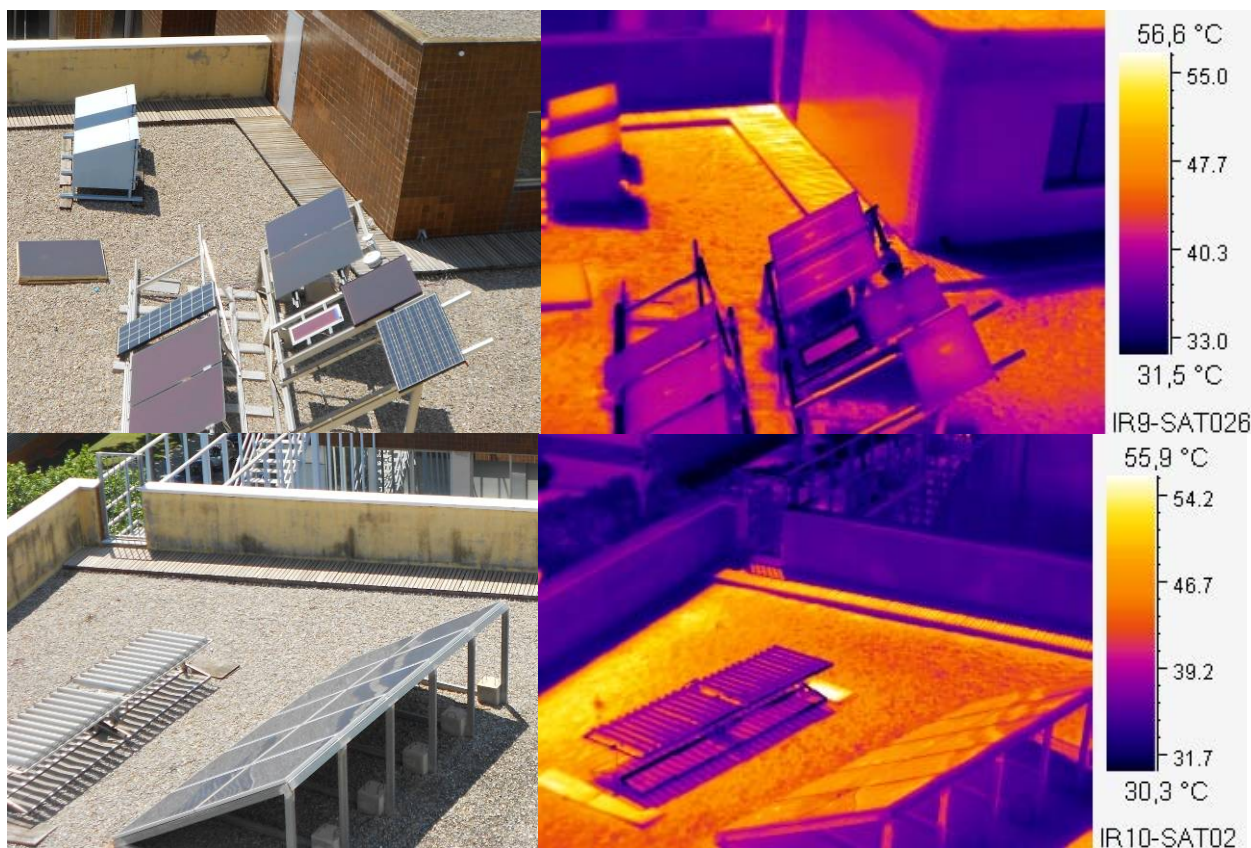
Figura 16. Imatges visible i infraroja de la coberta de l'aulari antic de Física. Font: Banc d'imatges OSSMA (25/07/2013).
