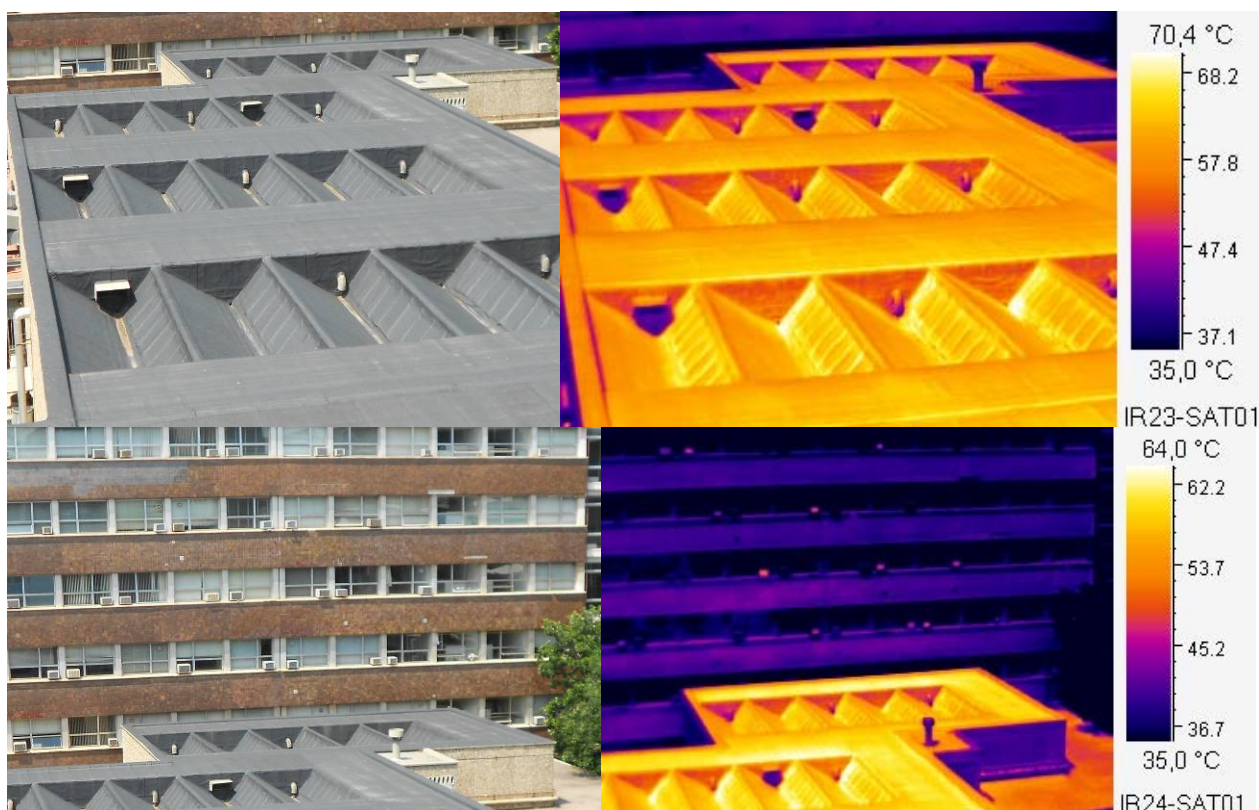
Figura 14. Imatges visible i infraroja de la coberta de l'aulari antic. Font: Banc d'imatges OSSMA (17/07/2013).
