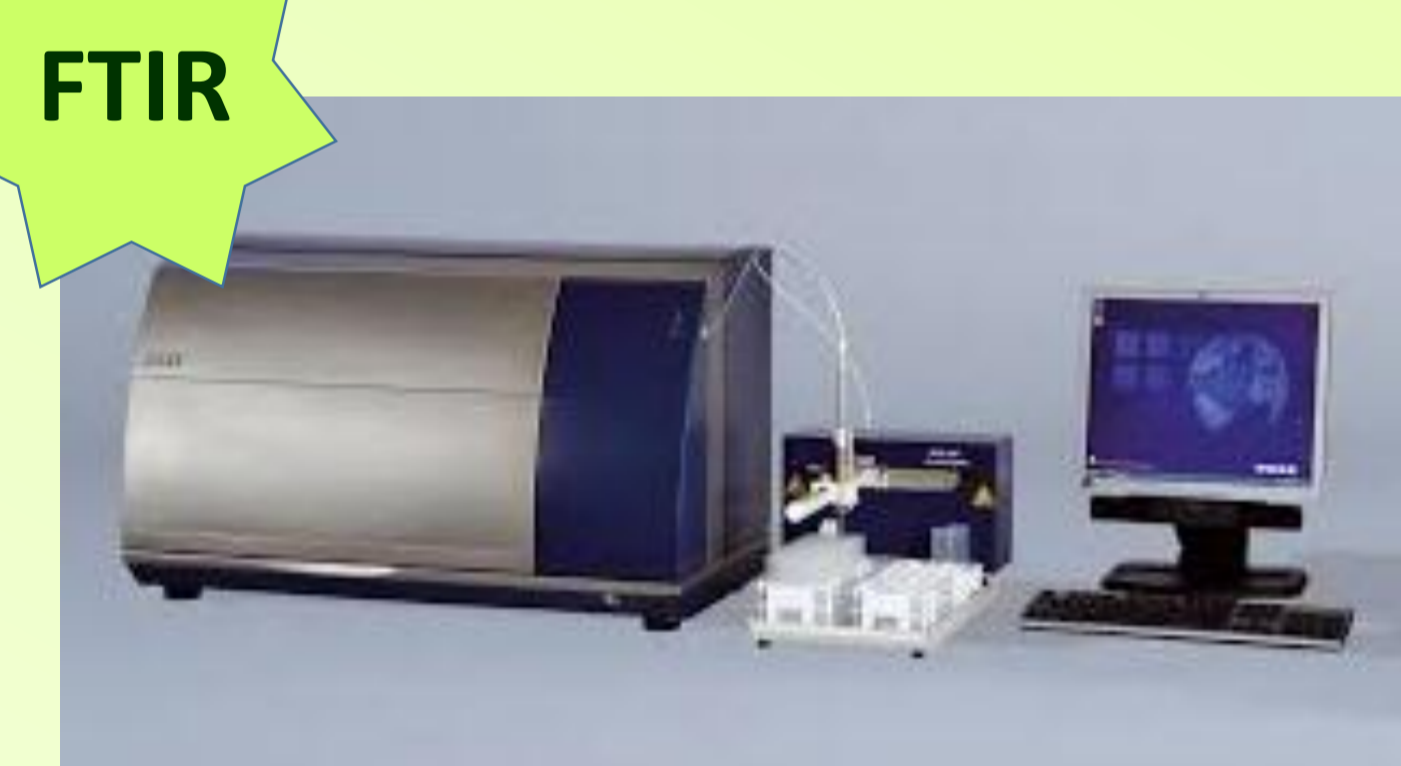
Espectrofotòmetre FTIR FT2 Winescan™ (Foss Electric, Hilleroed, Dinamarca)
